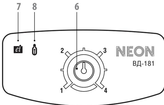
6 – Регулятор сварочного тока; 7 – Индикатор рабочего состояния; 8 – Индикатор срабатывания температурной защиты.
