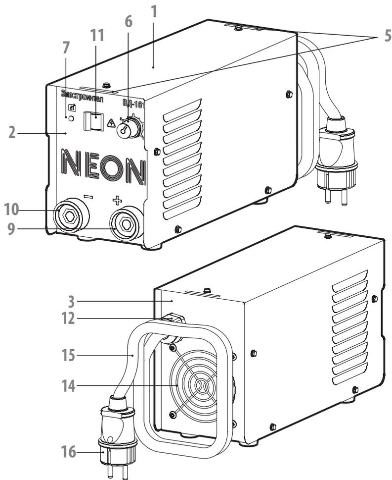
1 – Корпус выпрямителя; 2 – Лицевая панель; 3 – Задняя панель; 5 – Места крепления ремня для переноски;
