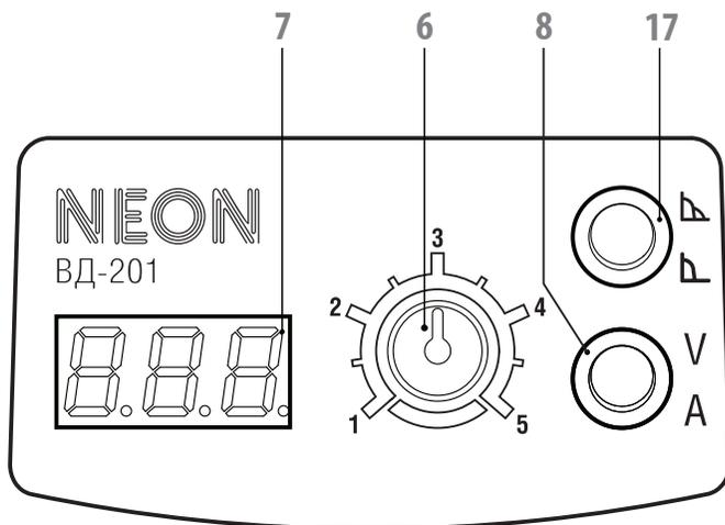
6 - Регулятор тока сварки; 7 - Трехразрядный цифровой индикатор; 8 - Переключатель режима индикации цифрового индикатора, 17 - Переключатель функции "ARCFORCE"
